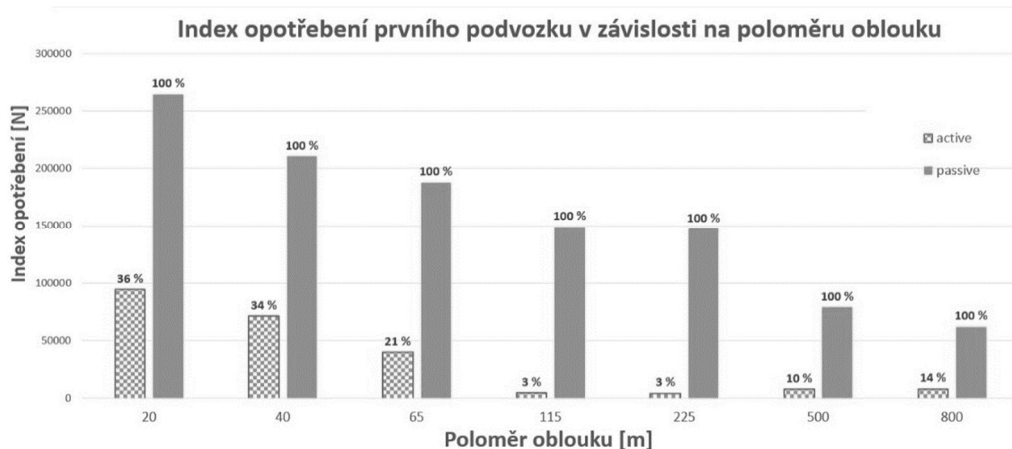
Obr. 5 – Číslo opotřebení prvního podvozku v závislosti na poloměru oblouku
