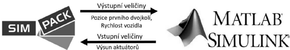
Obr. 2. Princip kosimulace využití k MBS výpočtům
