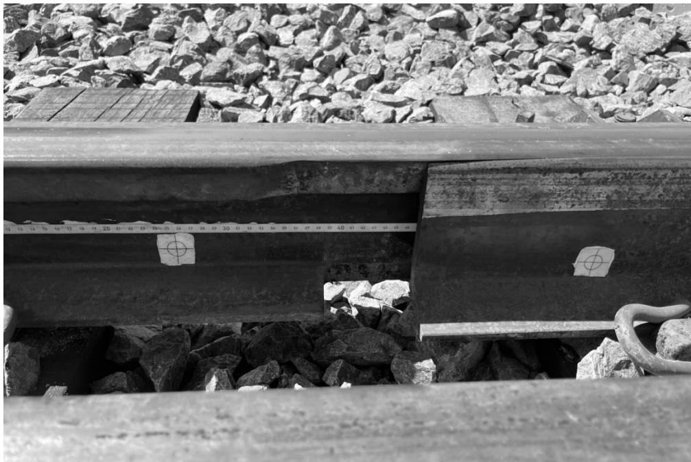
Obr. 2 Znárodnění způsobů měření vzájemné polohy jazkové a kolenové kolejnice
