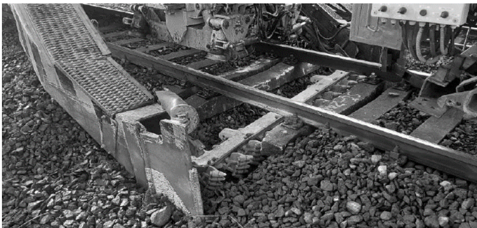
Obr. 1 Zakopaný těžící řetěz strojní čističky kolejového lože, zdroj: Ing. Vít Lojda, Ph.D. [3]
