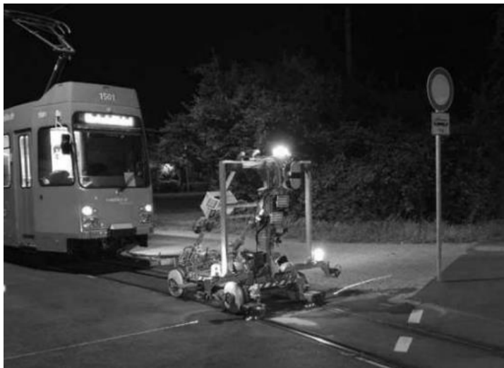
Obr. 3 Ukázka podobného měřicího zařízení pro zmapování tramvajové trati a jejího okolí [3]
