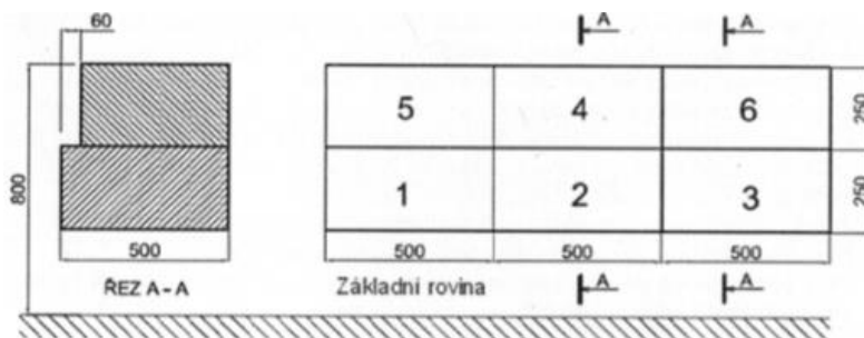
Obr. 6 Rozměry a tuhosti bariéry pro boční náraz, zdroj: [4]
