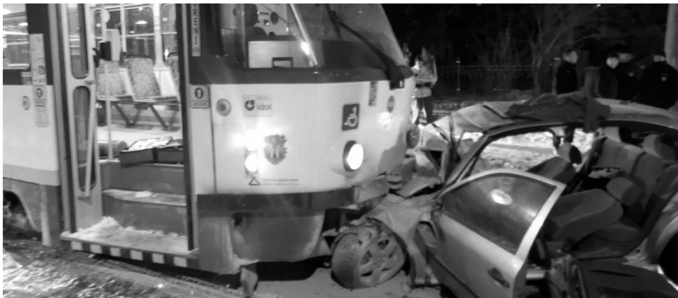
Obr. 4 Následky čelní nehody tramvaje s osobním automobilem (OA)
