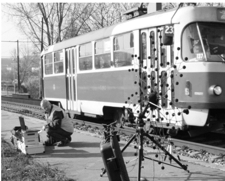
Obr. 3. Měření tramvaje Tatra T3SU
