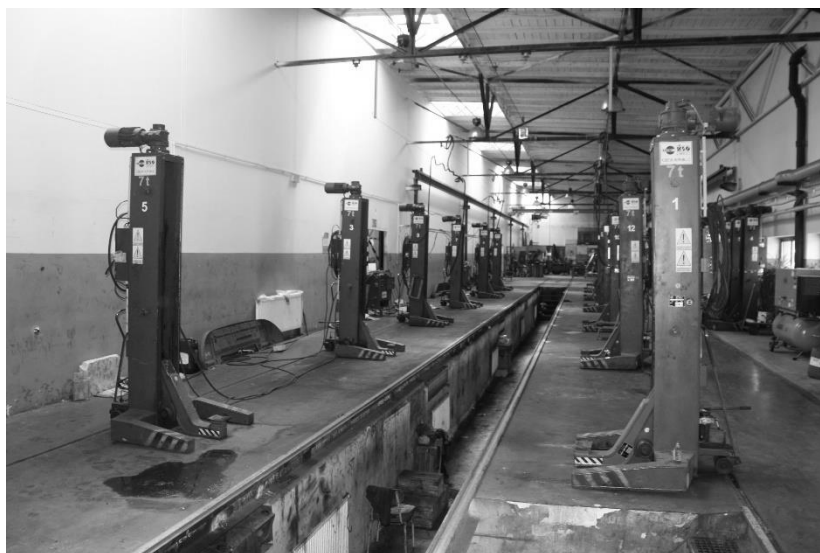
Obrázek č. 6 – Stanoviště pro zvedání tramvaje
