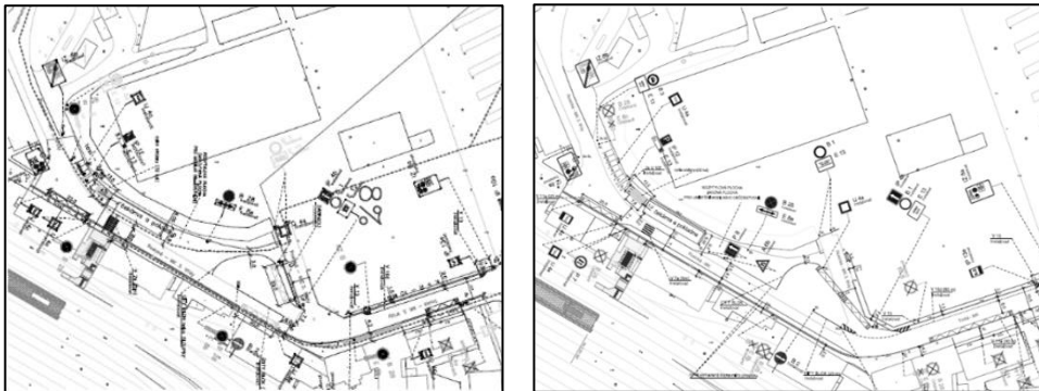
Obr. 2 – Brno-Dolní nádraží – Porovnání a) původního návrhu, b) nového finálního dopravního řešení, které bylo optimalizované opakovanými simulacemi [1].
